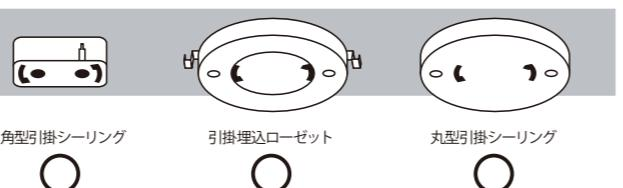
● 上面のシーリングボディがついていない場合は、専門の電気工事店へご依頼してください。シーリングボディの取付け電気工事の際は充分な長さの取付けネジ2本で天井の補強材のある位置に取付けてください。
